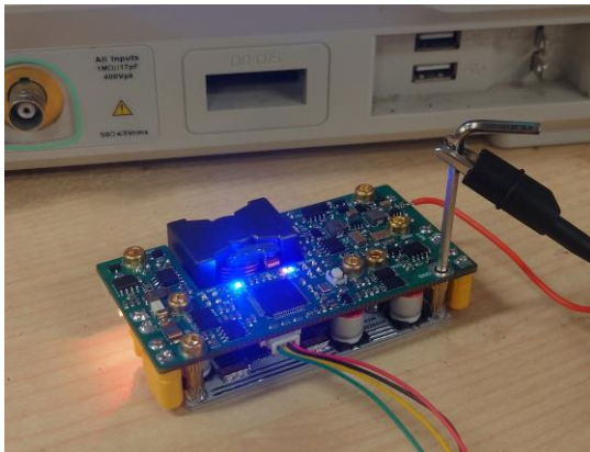
功率控制板 V3，超级电容部分峰值电路控制方案的验证板
